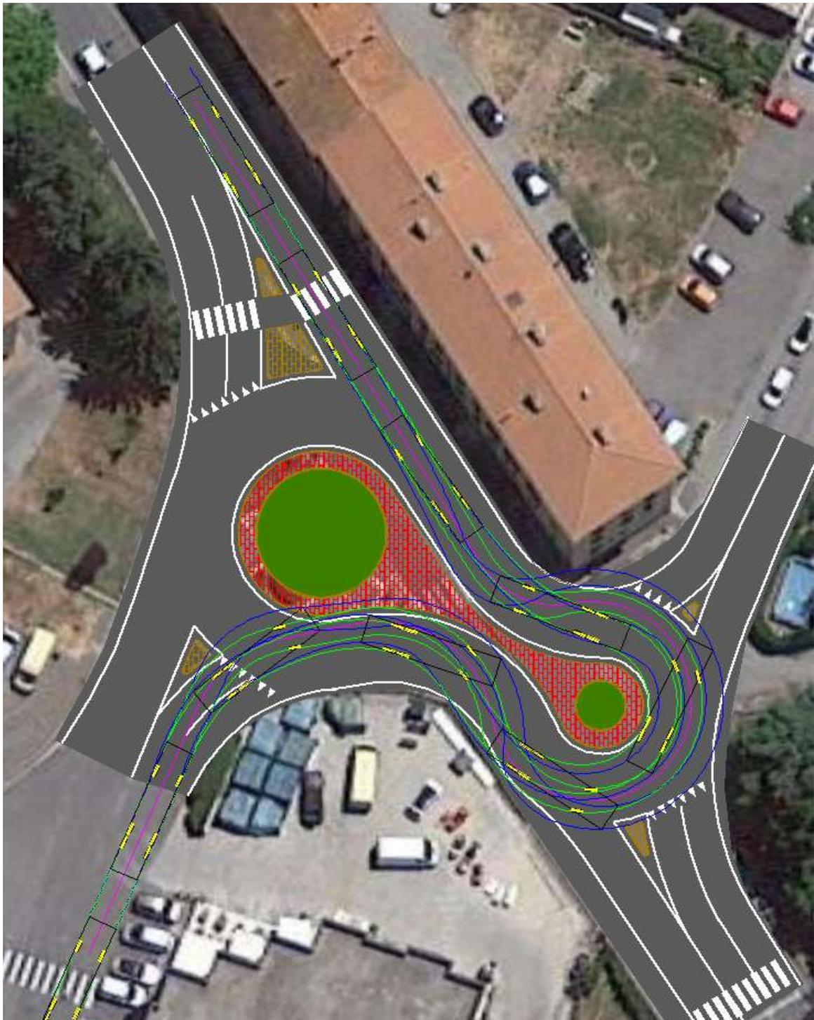
Fig. 6.10 - *Simulazione dinamica della manovra di svolta in sinistra di un autobus*
