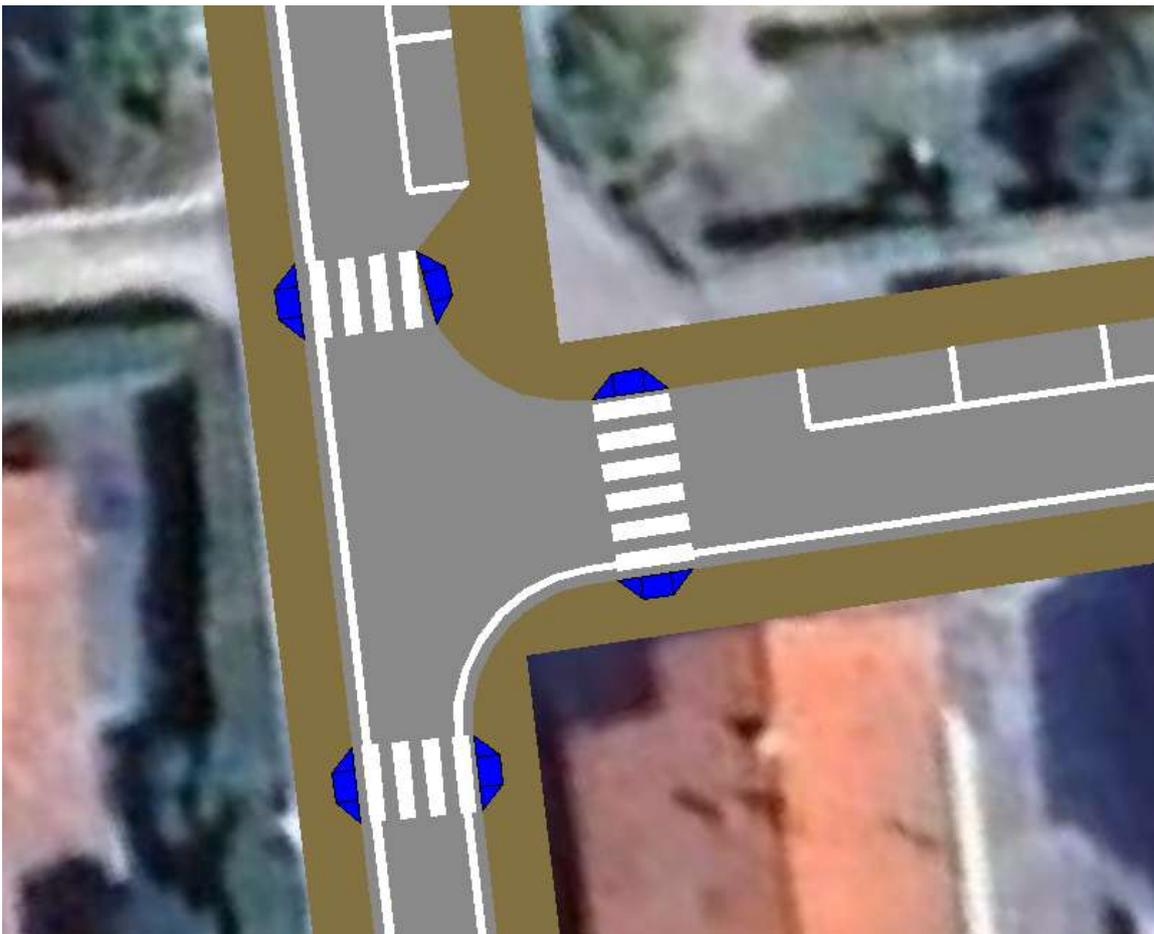
Fig. 7.4 - Allargamento marciapiedi in corrispondenza delle intersezioni
