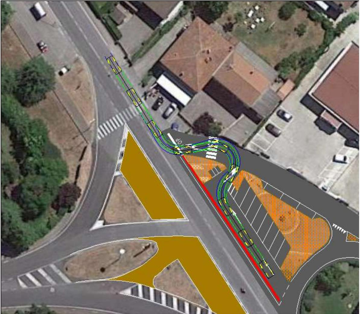
Fig. 6.6 - *Simulazione dinamica della manovra di ingresso/uscita da area di sosta*
