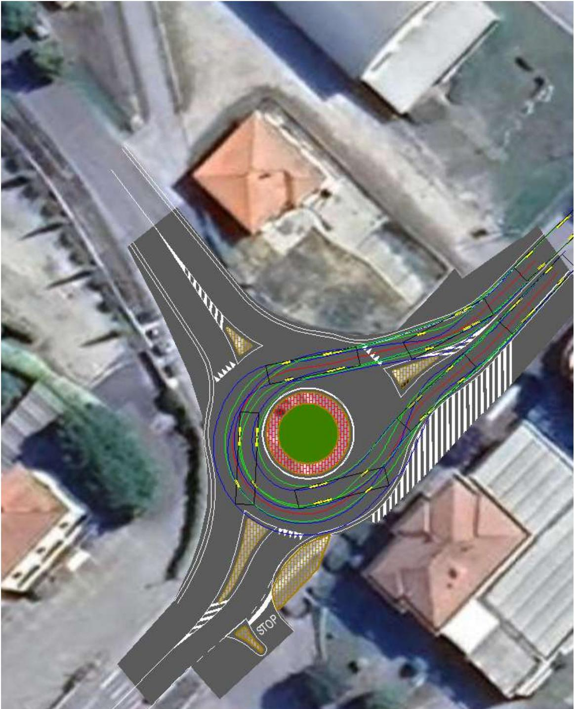
Fig. 6.17 - *Simulazione dinamica della manovra di inversione di marcia di un autobus*
